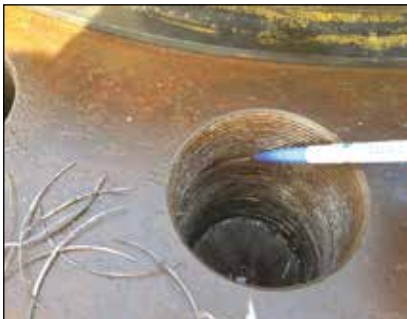
▲ Ein typisches Gewinde vor der Überholung
