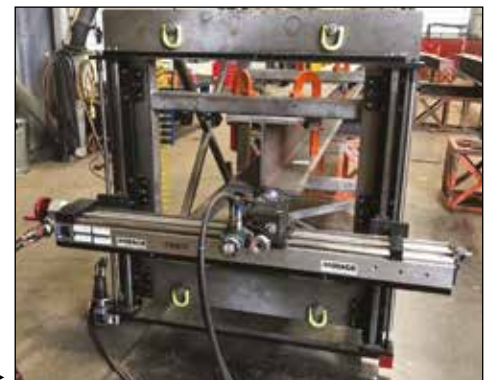
Stirnseitige Fräsbearbeitung eines T-Trägers mit einer GMRF1000. ▶
