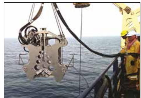
▲ Ins Meer abgeseckte MDWS-Diamantkettensäge.
