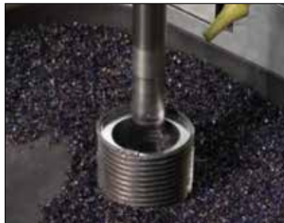
▲ Ausbohren der Mitte eines Bolzens (kleiner Durchmesser).
