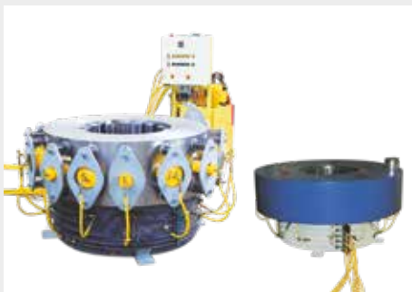
◀ Hochpräzisionsbundpresse, 600 t. Für die Herstellung von Beschleunigungsspulen ist die Umformung von Blech erforderlich.
